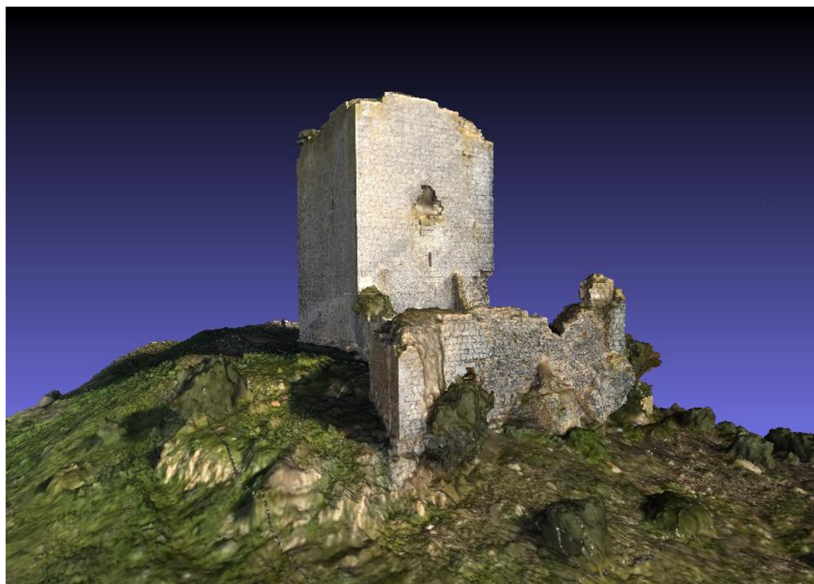
Reconstrucción virtual de la torre Lopera a partir de fotogrametría e imágenes tomadas con dron, Montellano. 2019.
