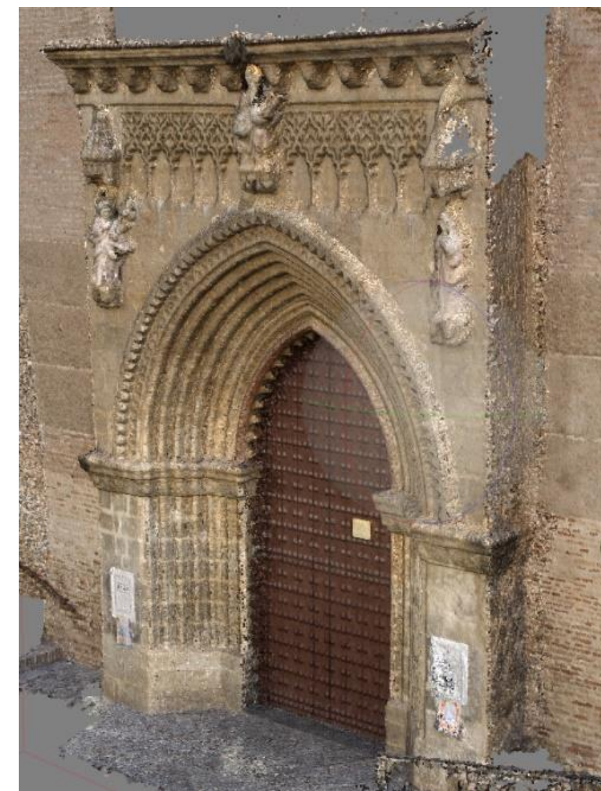
Nube de puntos para el levantamiento fotogramétrico de la portada de San Marcos, Sevilla. 2018.
