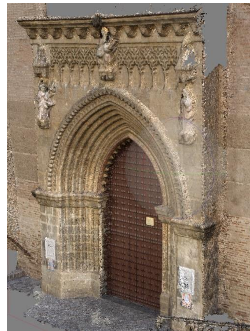
Nube de puntos para el levantamiento fotogramétrico de la portada de San Marcos, Sevilla. 2018.
