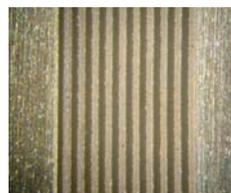
Latón surcos ancho 150 μm, profundidad 60 μm
